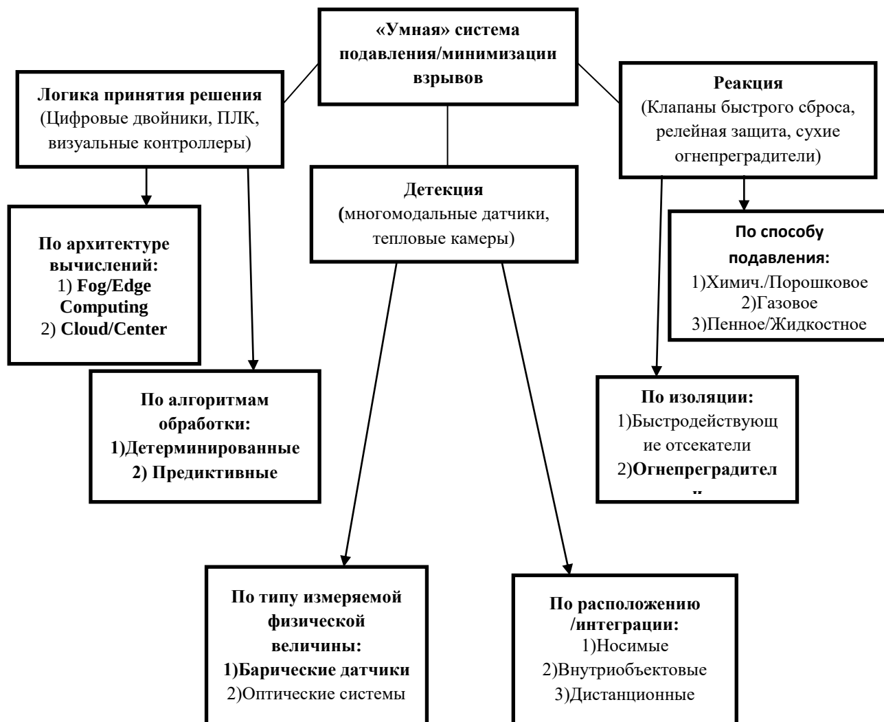
Рис. 1 Архитектура интеллектуальной системы подавления взрывов на основе технологий искусственного интеллекта, IoT и распределённых вычислений
